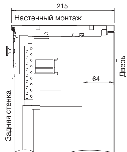
Шкаф с панелью учета
