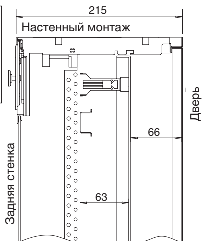
Шкаф с распре- делительной панелью
